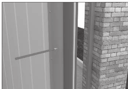
Разметьте отверстия для установки ручки.
